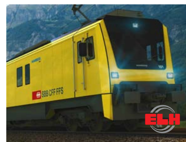
ELH Eisenbahnlaufwerke Halle SBB Erhaltungsfahrzeug St. Gotthard Switzerland DKWBZ 0714-4, 265 kW, 1,641 r.p.m.
